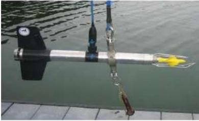
Current Meter digunakan untuk mengukur arus laut. Terdapat 2 metode utama yaitu Metode Euler yang digunakan untuk mengukur besar arus dan Metode Lagrange yang digunakan untuk menentukan arah arus permukaan. Terdapat beberapa tipe yaitu Acoustic Current Meter, Electromagnetic Current Meter, Acoustic Doppler Current Water Mass.
