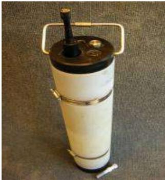
Alat yang digunakan untuk mengukur gelombang laut. Biasanya sih ya,, ini alat bisa mengukur tekanan dan gaya osilasi gelombang yang disebabkan oleh gelombangitu
